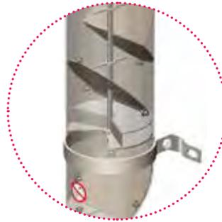
Индивидуальная система дозирования, которая точно отвешивает порции весом до 35 грамм.
